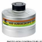
Filtre de type 450 cc. Boîtier en aluminium léger et résistant 107 mm de diamètre Ne réduit pas le champ de vision. Fixation au masque complet Sperian pour assurer une tenue fiable et une excellente étanchéité. Charbon de noix de coco active, imprègne et concasse. Capacité d'absorption extrêmement élevée. Filtre A2B2E2K2P3 a utiliser pour la protection contre les gaz toxiques de type A, B, E et K, mais également poussières et particules toxiques, aérosols solides ou liquides. EN 141
