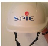
Casque de protection pour électricien ventilé. Calotte en ABS non aéré (léger), coiffe textile 6 points. Réglage crémaillère, visière réduite 3 cm. Jugulaire 4 points. Pour utilisation sur installations basse tensions. Marquage SPIE.
