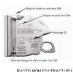
Antichute coulisseau. Câble 8mm en acier inox 7x19. Déplacement sur supports verticaux. Tirant d'air minimum : 2 mètres sous pieds de l'utilisateur. Résistance >1500daN. Poids : 0,400kg.
