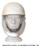
Casque de chantier électricien Idra de chez Auboueix. Il vous protégera contre l'arc électrique des courts-circuits basse tension. L'écran intègre est en polycarbonate d'une épaisseur de 2,2 mm. Il est de classe optique 1 avec un traitement antibuée intérieur et un traitement antirayure extérieur. L'écran de protection peut être verrouille en position relevée et en position de travail.
