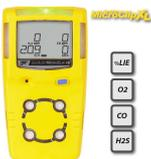
Détecteur de gaz 4 gaz portable de BW. En version 4 gaz standard, il mesure les concentrations en gaz explosibles (%LIE), en Oxygène (O2), en Monoxyde de Carbone (CO) et en Hydrogène Sulfuré (H2S)
